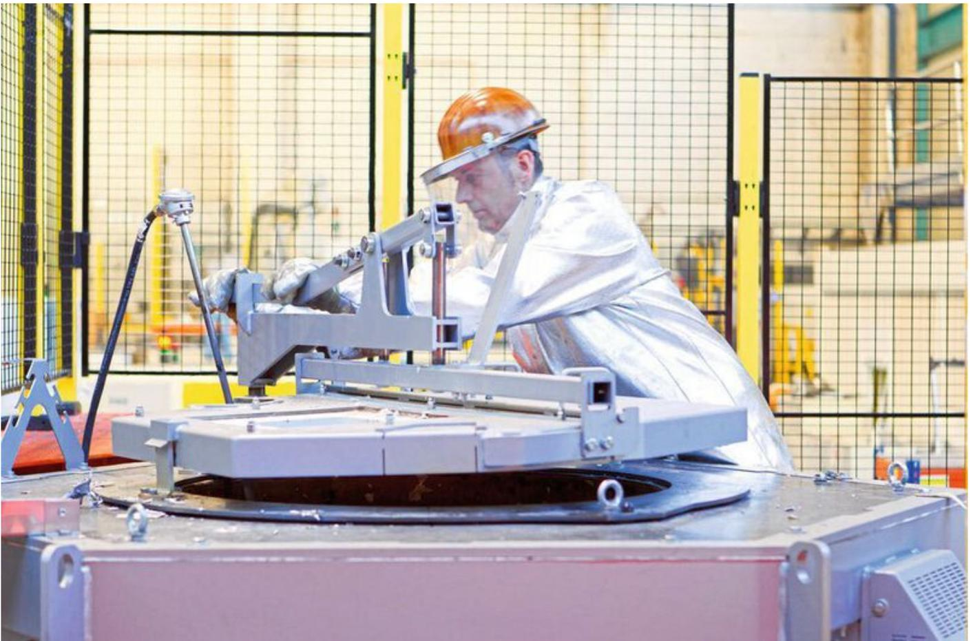
*Ein Mitarbeiter füllt Rohmaterial nach. Auch mit dem Einsatz von Sekundärmaterial lassen sich mittels Rheocasting hochqualitative Gussbauteile herstellen.*
